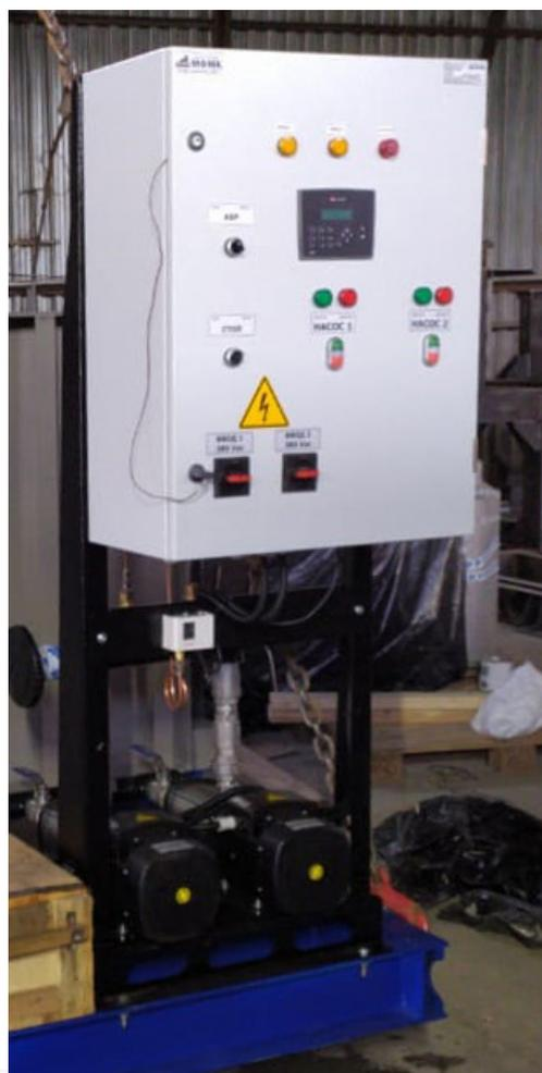
Готовый модуль зависимой системы отопления ГК МФМК на заводе
