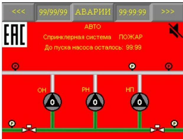
Главный экран контроллера при включении пожаротушения, спринклерная система с жокей-насосом
