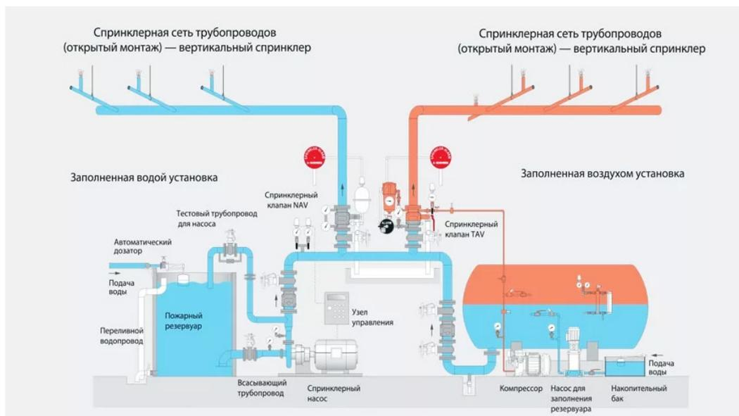
Пример спринклерной системы водяного пожаротушения
