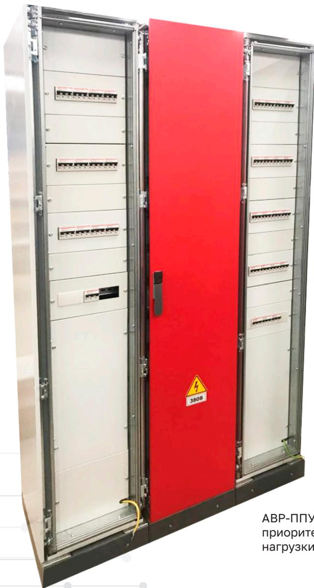
В щитах АВР предусмотрен выбор работы в двух режимах: автоматическое включение резервного ввода с приоритетом или ручное включение резервного ввода. По запросу на дверце щита АВР устанавливаются индикаторы контроля параметров электрической сети и включения АВР. Щит АВР может состоять из нескольких основных компонентов: панели вводов, панели отходящих линий, панели управления. Для АВР, питающих приоритетные пожарные нагрузки, щит может производиться в красном цвете (RAL3000).
