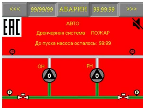
Главный экран контроллера при включении пожаротушения, дренчерная система
